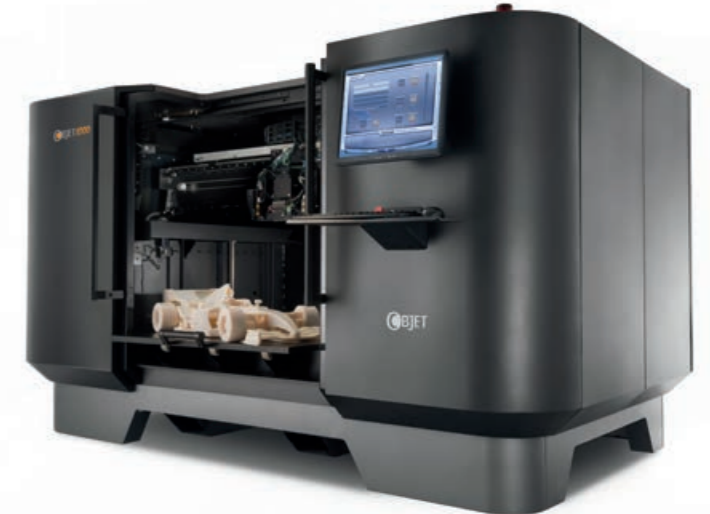
NEUE DIMENSION Der „Objet 1000“-Industrie-3D-Printer von Stratasys. Printen im Format von 1 m Breite und 80 cm Höhe
